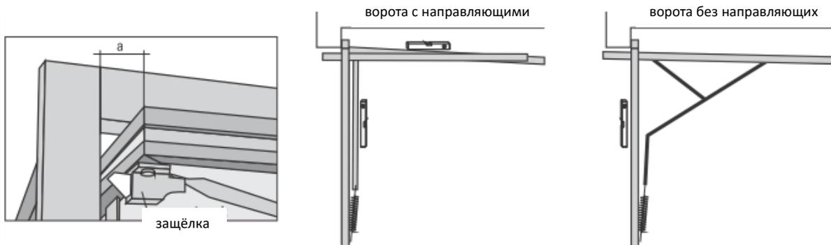
2. При полностью открытых воротах полотно должно находиться в горизонтальном положении, защёлка должна выступать за раму, а ролики в направляющих должны соприкасаться с отбойниками (в случае необходимости проведите регулировку отбойников).
